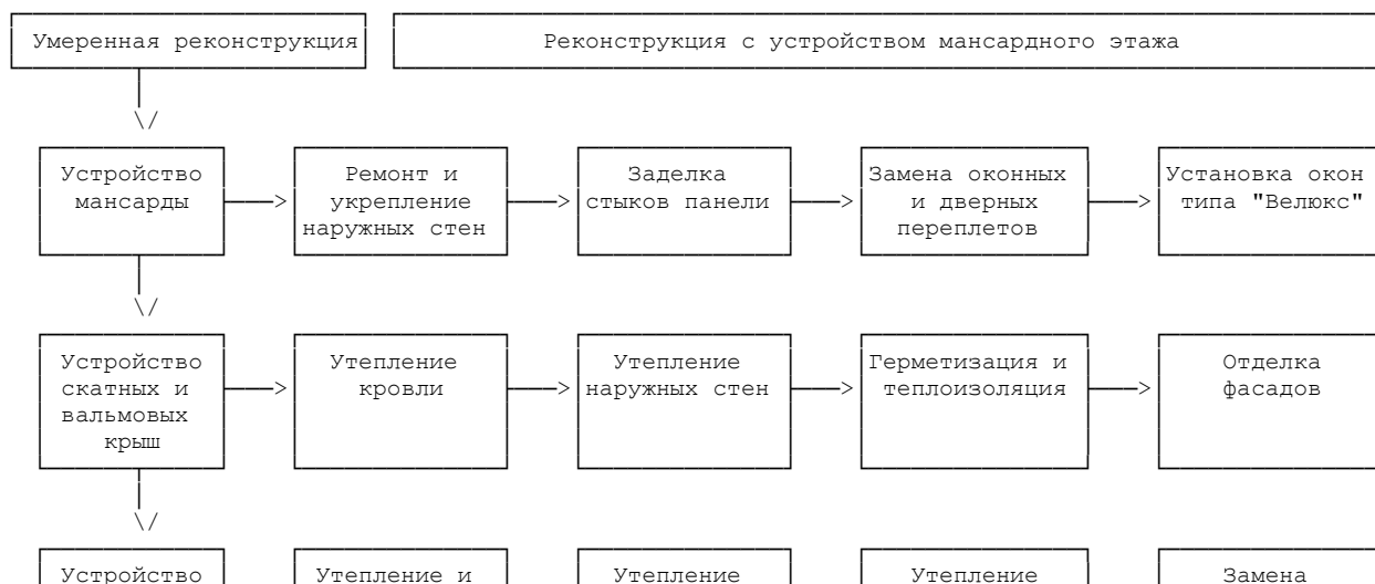
Рис. 2.1. Пример реконструкции жилого здания первого поколения с надстройкой мансардных этажей без расселения (жирным шрифтом выделены работы по капитальному ремонту)
